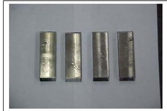
Figura 12 – superfície de trabalho (desgaste)
