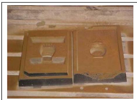
Figura 9 – moldes preparados para confecção das mandíbulas
