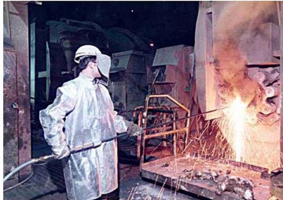
**Figura 1.** Operação de Lanças de Oxigênio com Equipamento de Segurança
