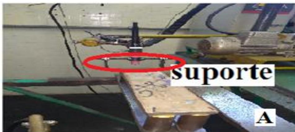
**Figura 1-** a) suporte para adição do campo magnético.
