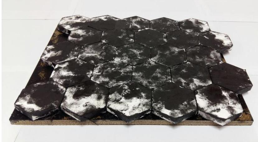
**Figura 4.** Configuração final antes do teste balístico do SBM.
