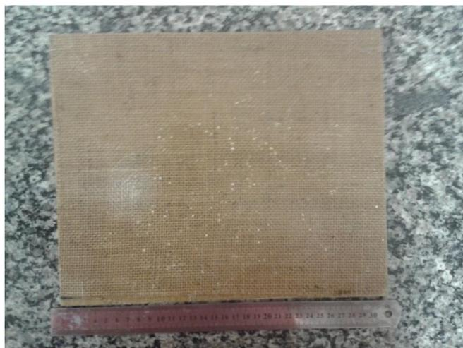
**Figura 2.** Compósito de matriz epóxi reforçada com 30% em volume de tecido de juta.
