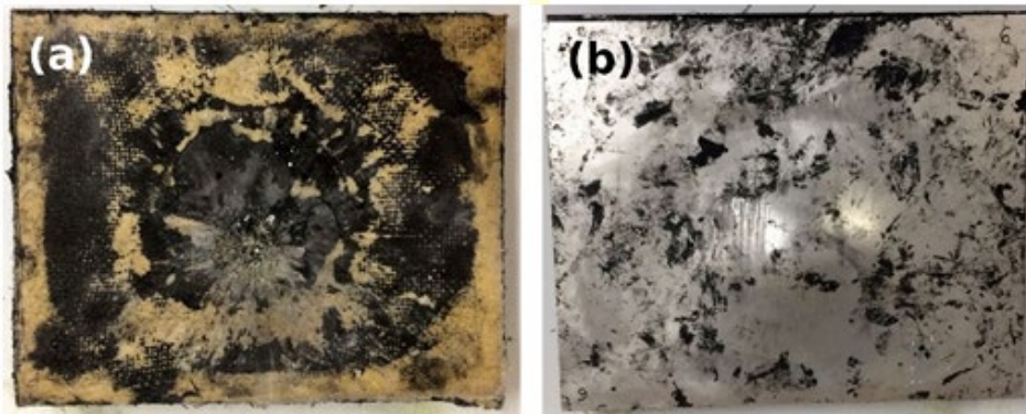
Figura 3 - Aspecto geral do SBM 011 após o teste balístico: (a) frente; (b) fundos.
