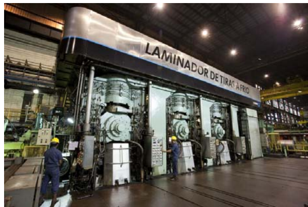
Figura 1 - Laminador de Tiras a Frio da Usiminas Cubatão.
