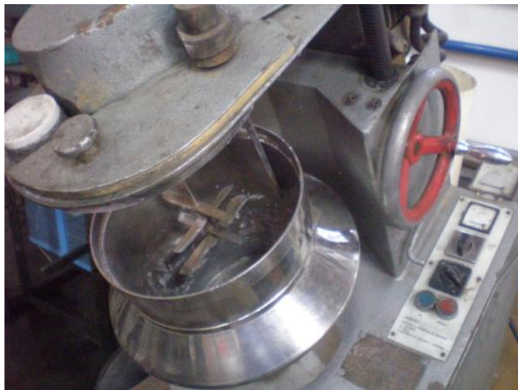
Figura 2: Misturador Eirich utilizado para homogeneização do material.
