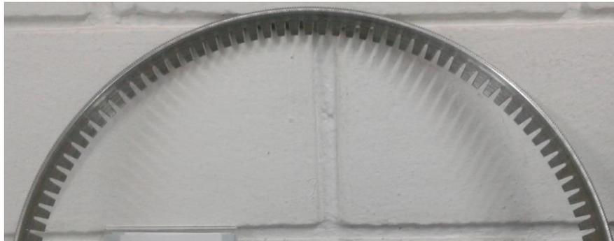
**Figura 7.** Lâmina rotativa produzida com aço 22MnB5.
