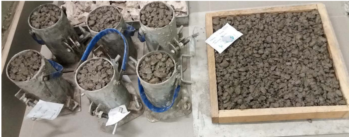
Figura 3. Corpos de prova cilíndrico e placa (prismático). Fonte. Elaborada pelo autor.
