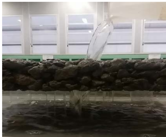
Figura 5. Teste de permeabilidade do concreto. Fonte. Elaborada pelo autor.
