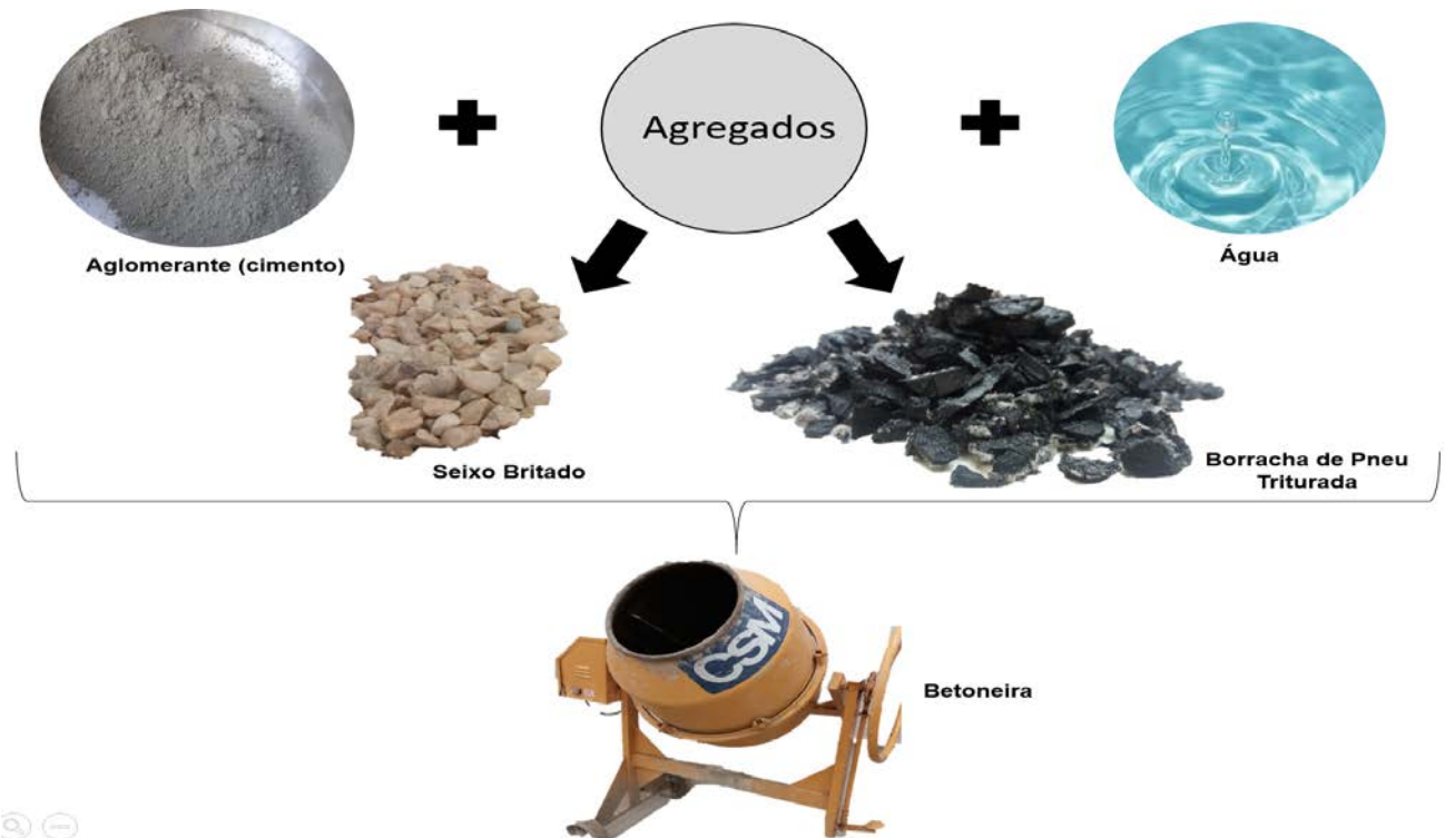
Figura 3. Materiais e método utilizado para a dosagem do concreto poroso. Fonte: Elaborada pelo autor.
