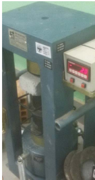
Figura 4. Teste de resistência à compressão. Fonte. Elaborada pelo autor.
