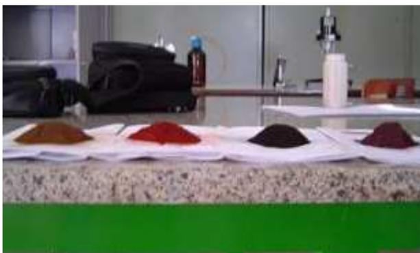
**Figura 1.** Pigmentos marrom, vermelho, preto e roxo sintetizados em escala laboratorial.
