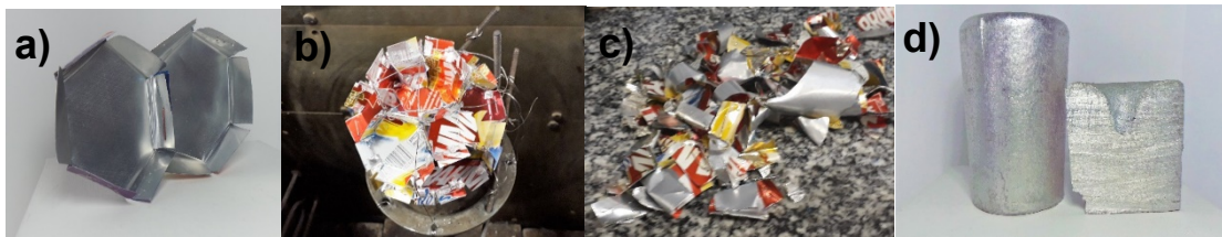
Figura 2. Reaproveitamento das latinhas. a) fixação do molde com grampo; b) encaixe do molde na máquina de rotomoldagem; c) molde após o desmolde; d) lingote feito do molde
