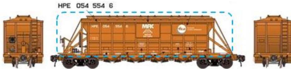
**Figura 1** – Vagão HPE destacando sua Superestrutura
