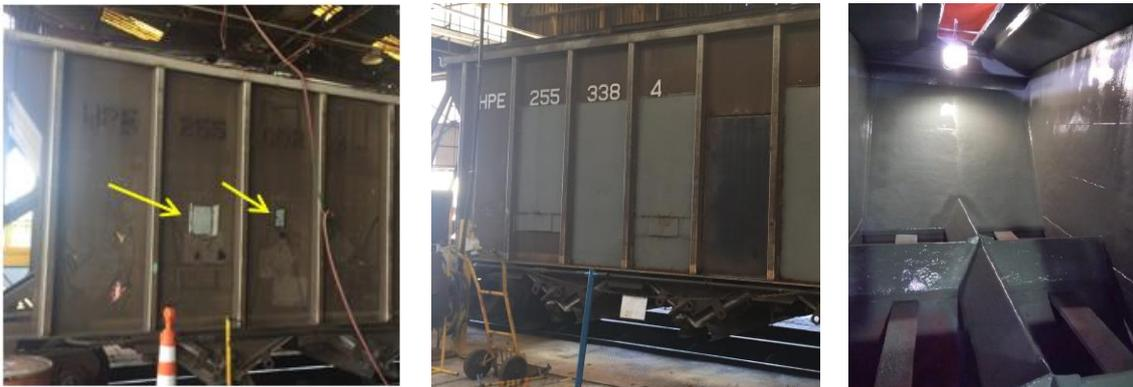
Figuras 4, 5 e 6 – Tapa Buraco / Substituição da Chaparia / Revestimento Interno
