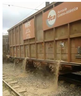
Figura 8 – Vazamento de carga
