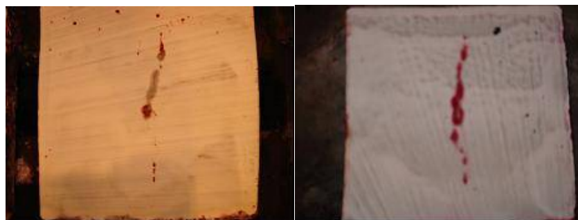
Figura 9. Presença de trinca central nos tarugos.
