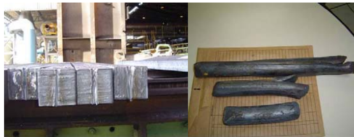
Figura 8. Detalhe do defeito induzido nos tarugos para o teste da qualidade do corte e o resultado dos testes na barra laminada apresentando o defeito de ponta aberta.
