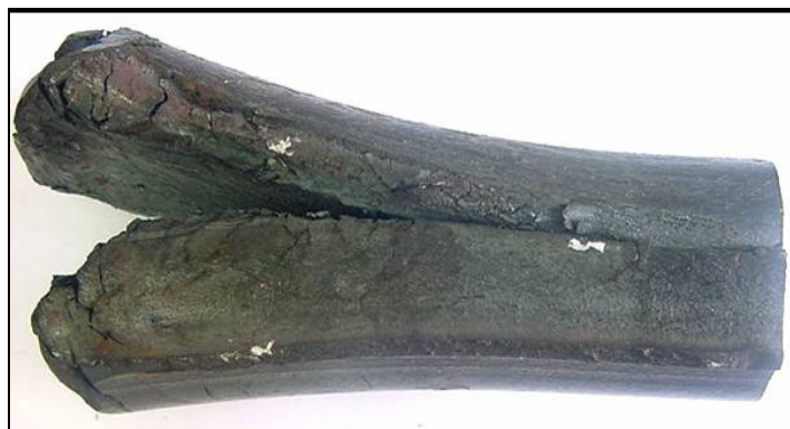
Figura 1. Aspecto macrográfico do defeito “Ponta Aberta” em uma barra redonda.
