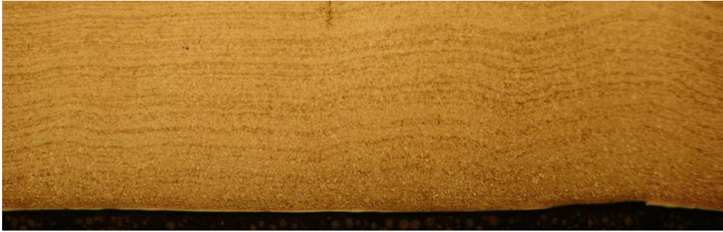
Figura 10 – Microestrutura do corte adequado – 100x.
