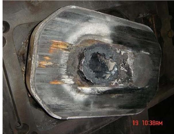
**Figuras 4 e 5:** Marcas esbranquiçadas indicando oxidação por infiltração de ar.
