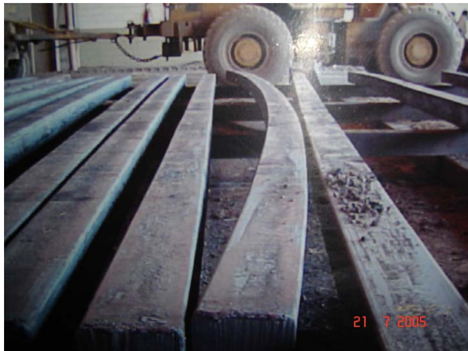
Figura 2. Tarugo empenado por transformação de fase
