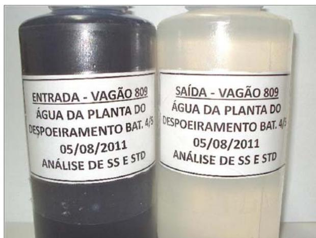
Figura 16. Água de entrada x água de saída do S MDF.
