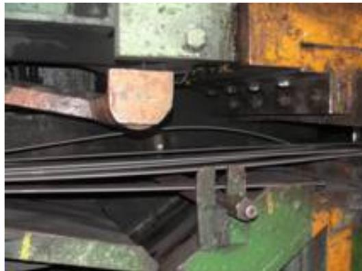
**Figura 7.** Resultado da dilatação e contração do material no leito de resfriamento.
