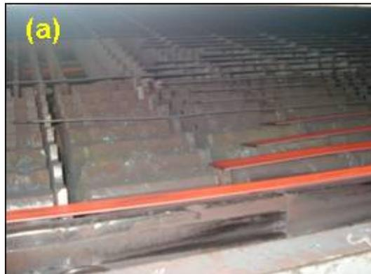
Figura 5. Contração da barra no leito de resfriamento.
