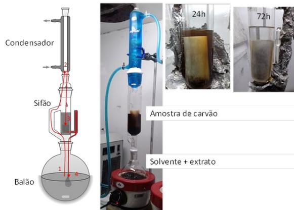
**Figura 3.** Extração por solvente via soxhlet dos carvões de estudo.
