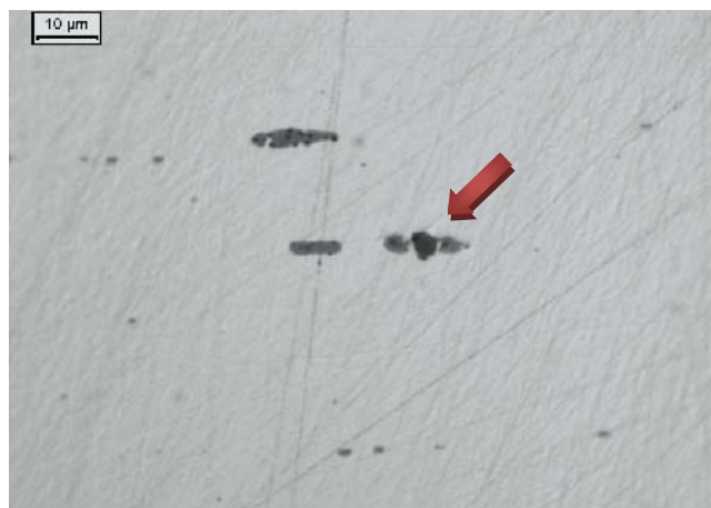
Figura 6. Pite (indicado pela seta) se formando em inclusão (cinza clara) - amostra de 38% deformação após polarização potenciodinâmica em solução 0,1M NaBr.
