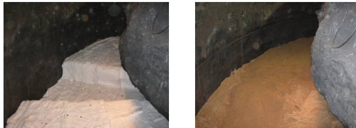
Figura 15. Proteção do cadinho prevendo o corte da salamandra.
