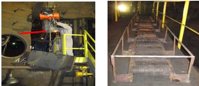
Figura 9. Dispositivos para retirada dos blocos de carbono.
