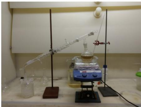
Figura 1 – Processo de destilação simples do MMA
