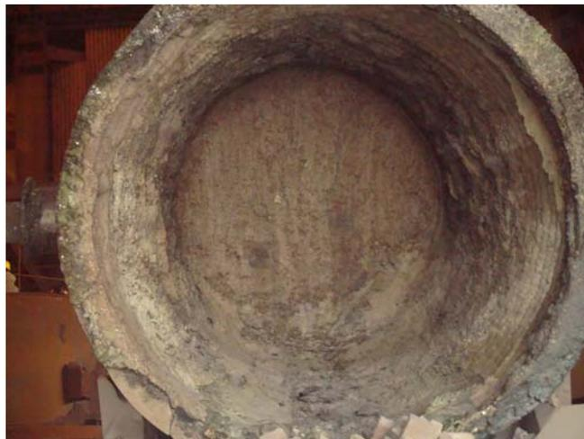
Figura 10: Desgaste refratário na panela de aço.
