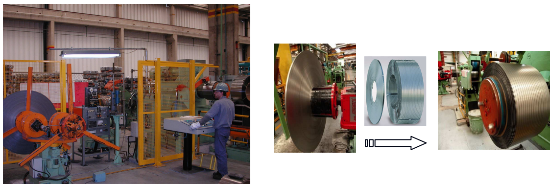
Figura 6: (a) Máquina de oscilar com capacidade para rolos de até 3,0t e (b) rolos/carretéis. (8)
