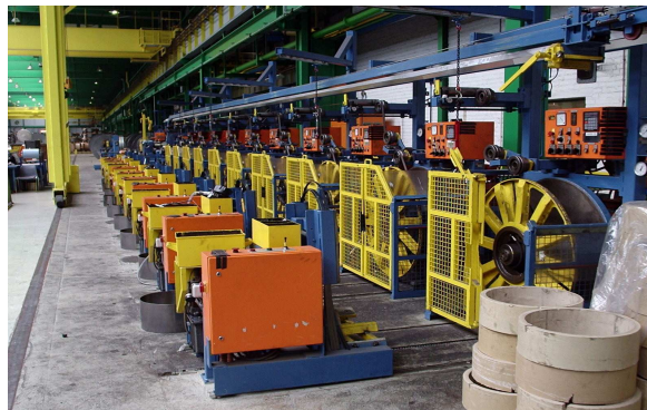
Figura 5: Tesoura de corte longitudinal (10 bobinadeiras) da empresa CDW. (7)
