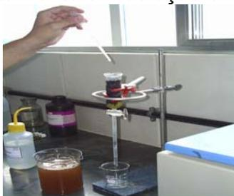
**Figura 9.** Filtração em coluna de carvão ativado do efluente tratado por Permanganato de potássio
