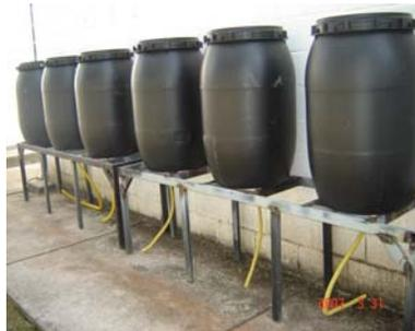
**Figura 1** Conjunto de células piloto(lisímetros) para captação do líquido percolado
