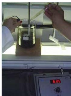
**Figura 3.** Foto mostrando a adição de  $H_2SO_4$  para redução do pH
