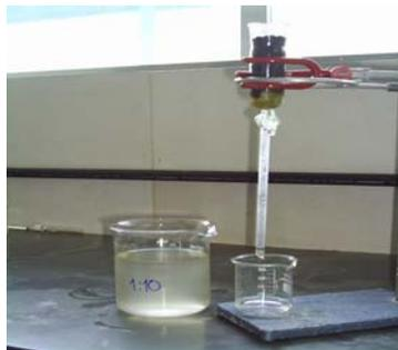
**Figura 6.** Filtração em coluna de carvão ativado do efluente tratado por ácido de caro
