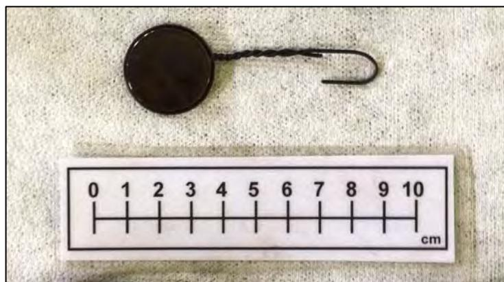
**Figura 1.** Amostra em aço AISI 316L após a cementação sob plasma.
