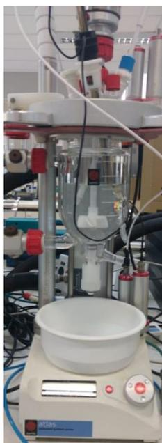
**Figura 1.** Reator em batelada Atlas Sodium 1.4 utilizado nos ensaios de lixiviação da lama vermelha.
