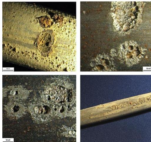
Figura-6: Forte processo corrosivo no trocador teste do *Sentinel* na Corrida #1
