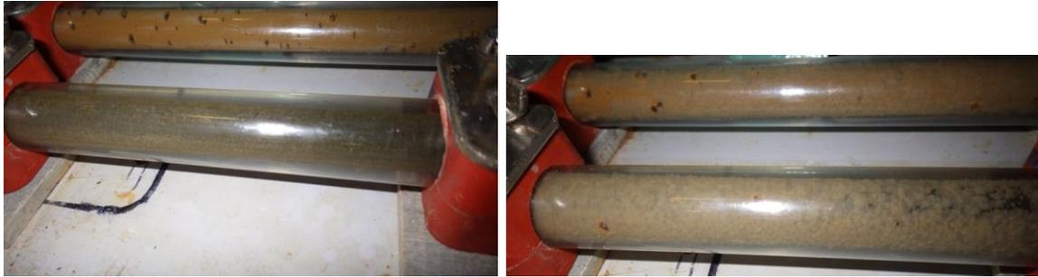
Figura-10: Observação visual dos tubos-teste no *Sentinel* antes e após a falta de dosagem de oxidante
