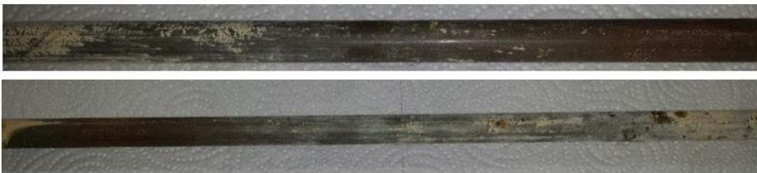
Figura-12: Corrida #5: Presença suave de incrustação e sem corrosão localizada ou notória
