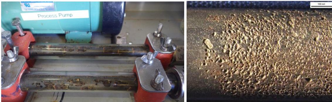
Figura-11: Corrida #4: muito pouca deposição de fosfato de ferro após 126 dias de exposição; corrosão localizada ainda visível em áreas dispersas (11 mills na foto do tubo)
