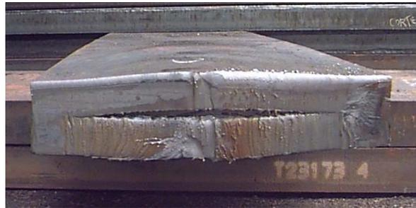
**Figura 6.** Trincas abertas por H.
