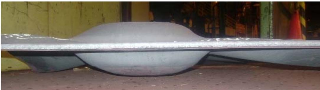
**Figura 8.** Bolsas formadas por Hidrogênio durante processo de Laminação.
