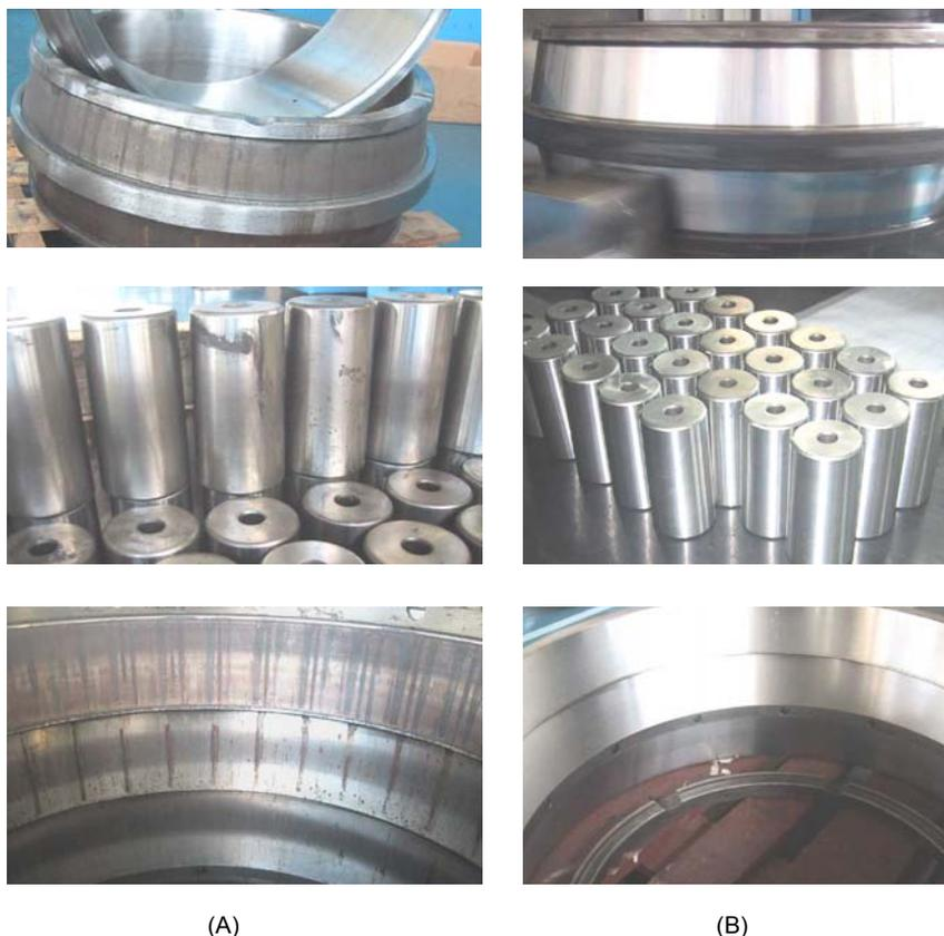
**Figura 4.** Componentes do rolamento antes (A) e depois (B) do reparo.
