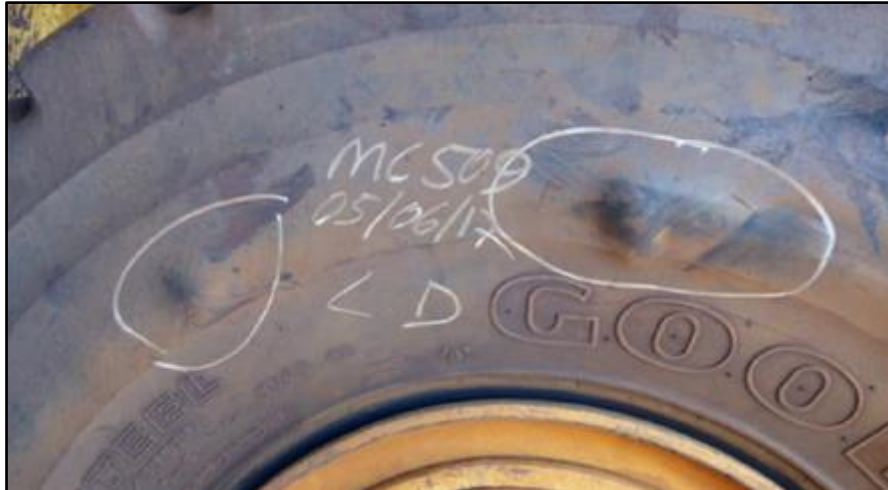
Figura 5. Pneu com infiltração de ar no talão.
