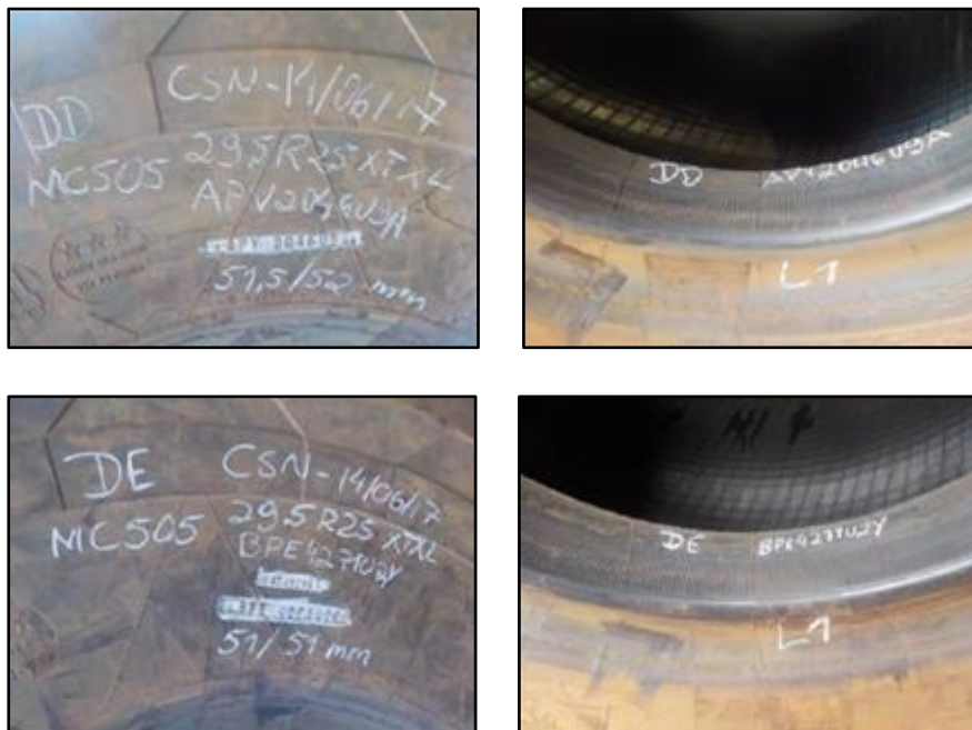
Figura 10. Inspeção do talão dos pneus após 1.800 horas em operação.
