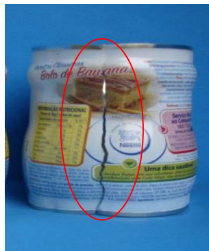
Figura 2 - Face exterior da lata rompida após seu processo de expansão
