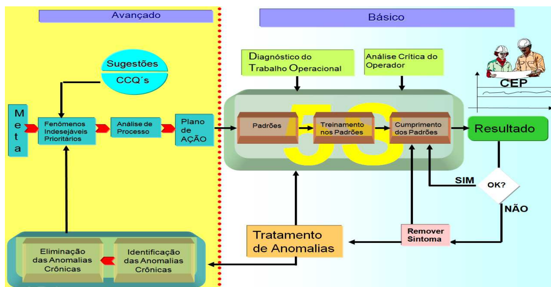
Figura 9 – Seqüência para aplicação do gerenciamento da rotina ou da melhoria, no laminador de tiras a frio da CSN. (4)
