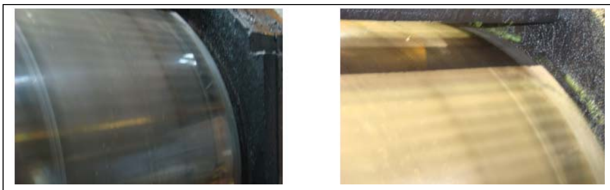
Figura 5 – Marcas impressas no cilindro de encosto do laminador devido a ocorrência de chatter de 5ª oitava. (3)
