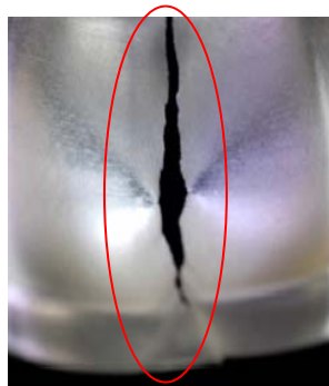
Figura 1 - Face interior da lata após seu processo de expansão
