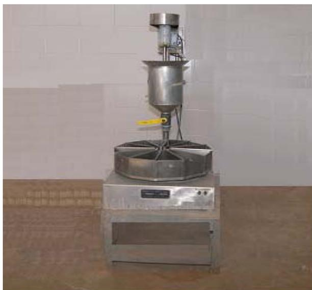
FIGURA 2.4 – Quarteador de polpa utilizado para quarteamento de amostras obtidas em operações piloto e/ou industrial.
