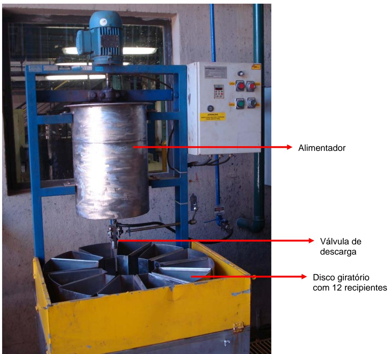
FIGURA 3.1 – Foto do Quarteador de Polpa do Laboratório de Processo
