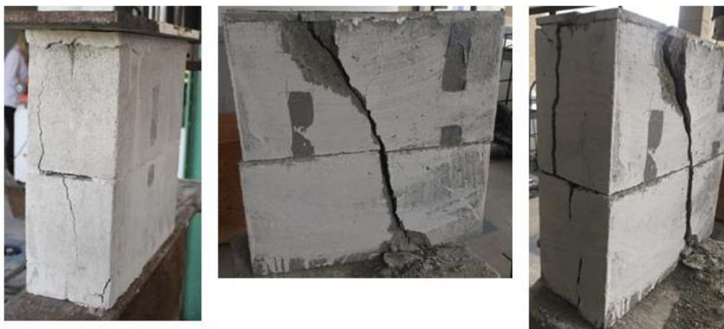
Figura 3. Modo de ruptura dos prismas com argamassamento parcial.
