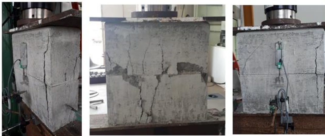
Figura 4. Modo de ruptura dos prismas com argamassamento total.
