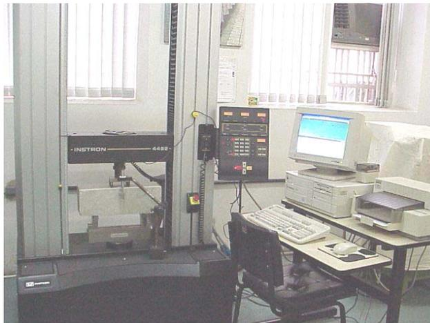
Figura 3 – Equipamento utilizado para ensaio de tração.
