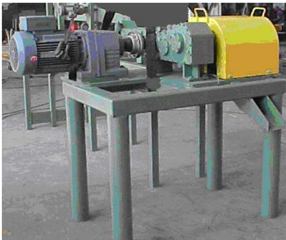
Figura 2 - Montagem da caixa redutora na máquina de corte de pastilhas de aço (sucata).
