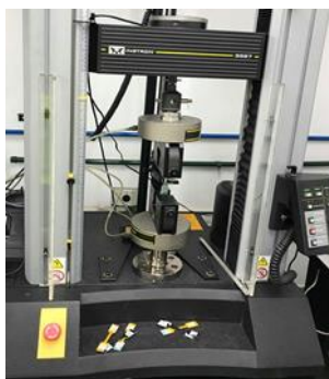
Figura 3. Ensaio de tração na a) Instron 5567 b) Corpos de prova de acordo com a norma ASTM E8/E8M-16 a [8] (Autor, 2019).
