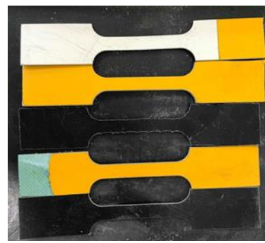
Figura 3. Ensaio de tração na a) Instron 5567 b) Corpos de prova de acordo com a norma ASTM E8/E8M-16 a [8] (Autor, 2019).
