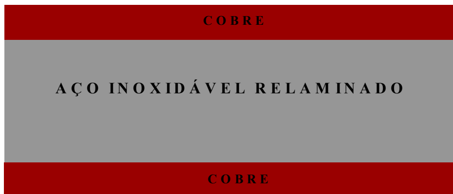
Figura 4 – Esquematização da composição da camada de cobre, composto de 8microns (0,008mm) - revestimento na face e contra face do aço.
