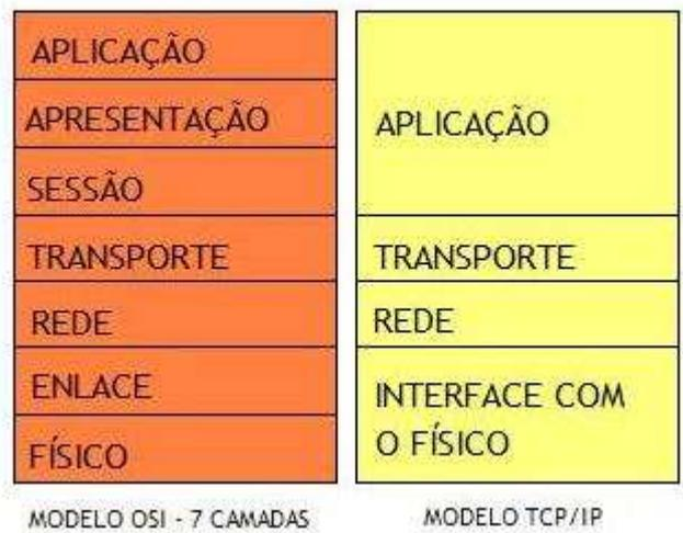
**Figura 1** – Modelo OSI de camadas de rede e equivalência com o TCP/IP.
