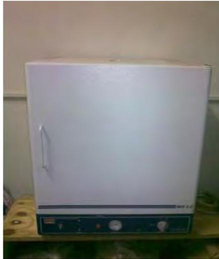
**Figura 7.** Estufa utilizada na secagem das fibras.
