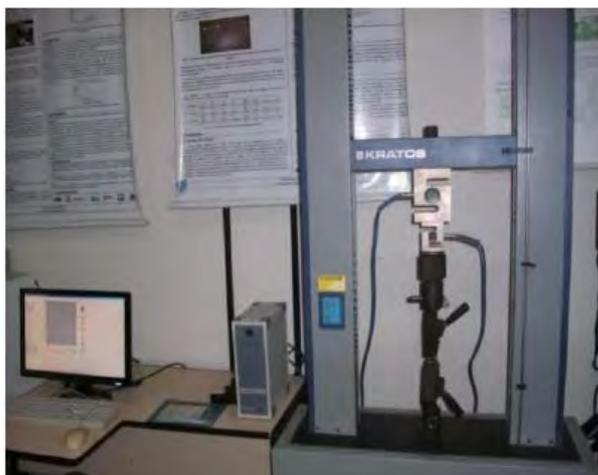
Figura 4. Máquina de ensaio de tração.
