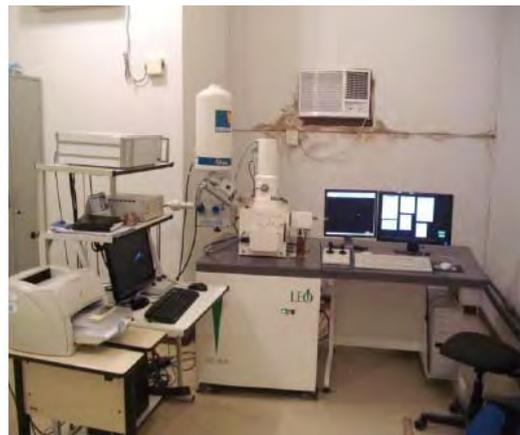
**Figura 8.** Máquina de microscopia eletrônica de varredura.
