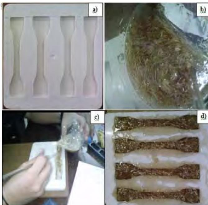
**Figura 9.** Processo de confecção dos corpos de prova: a) Molde de silicone utilizado para confecção dos corpos de prova; b) As fibras sendo misturadas com a resina e agentes de cura em um Becker antes de serem vazadas no molde; c) A mistura já homogeneizada sendo vazada no molde sem pressão; d) Compósitos particulados já fabricados e vazados no molde esperando o tempo de cura para serem ensaiados.
