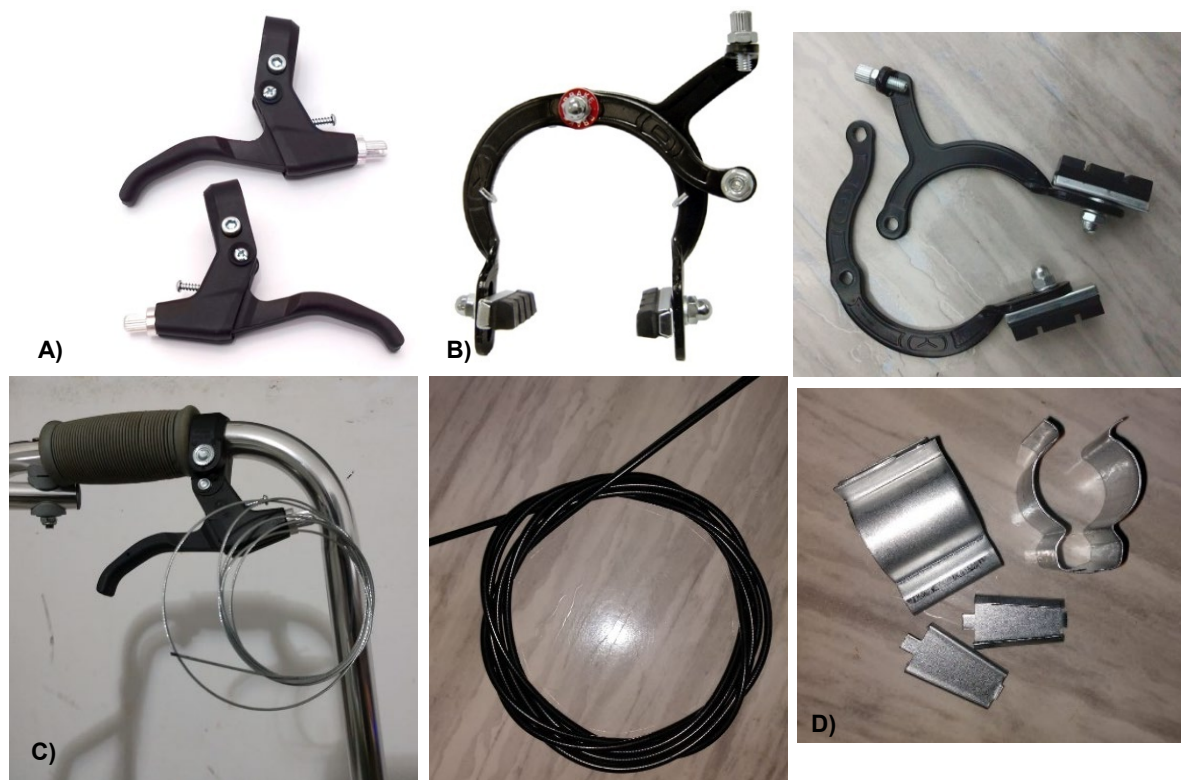
Figura 3 – A - Maçaneta para acionamento do freio. B - Freio ferradura para acionamento do pino de trava da altura do andador. C - Cabos e conduítes empregados no mecanismo. D - Braçadeiras utilizadas para a fixação do mecanismo no tubo do andador.
