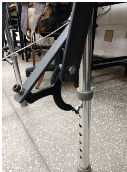
Figura 11 – Execução do projeto final do sistema de regulagem de altura para andadores. Fonte - Autores
