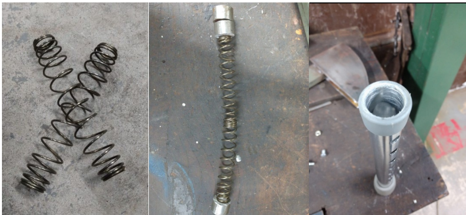
Figura 9 – Mola auxiliar no mecanismo responsável pelo retorno dos tubos.
