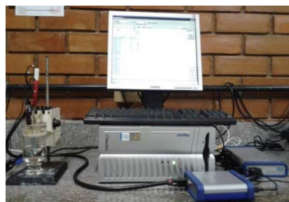
Figura 2. Equipamento de ensaios eletroquímicos Potenciostato/Galvanostato e analisador de Impedância IVIUM.
