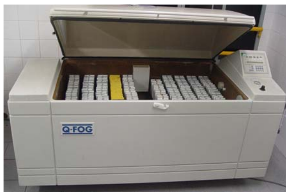
Figura 2 - Câmara Q-Fog da Q-Panel Company com volume de 1100 L para testes acelerados cíclicos de corrosão, utilizada no teste GM 9540P.
