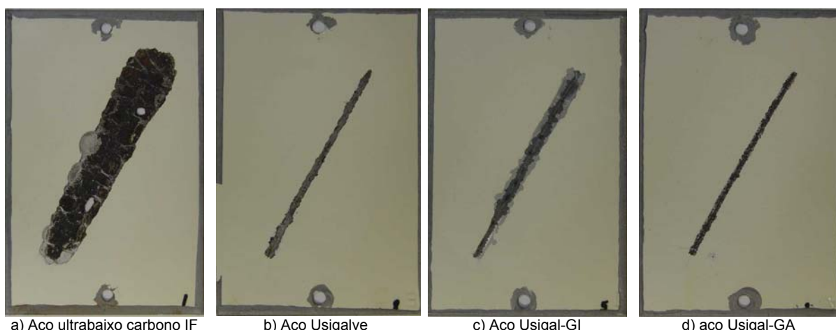
Figura 6 - Aspecto dos corpos-de-prova após 1920h (80 ciclos) de teste acelerado cíclico de corrosão GM 9540P.
