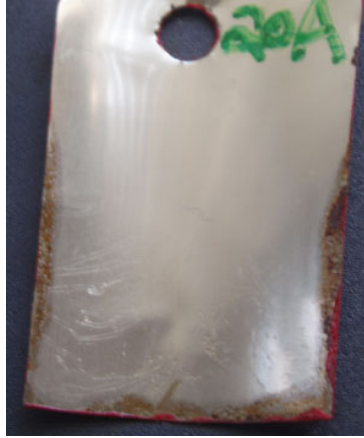
Figura 4: Placa de aço após 60 dias de imersão.
