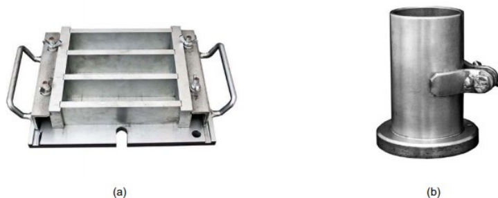
Figura 4. Moldes utilizados para fabricação dos corpos de prova.
