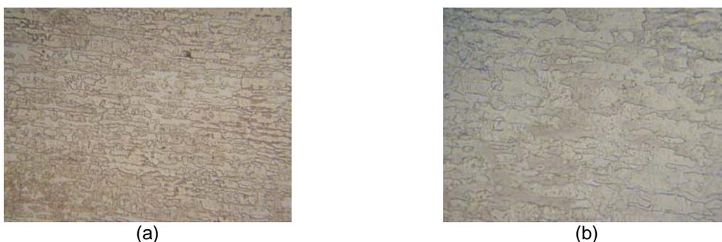
Figura 5. Micrografias óticas do aço super-duplex laminado atacado com água régia. Aumento de (a) 500x e (b) 1.000x.
