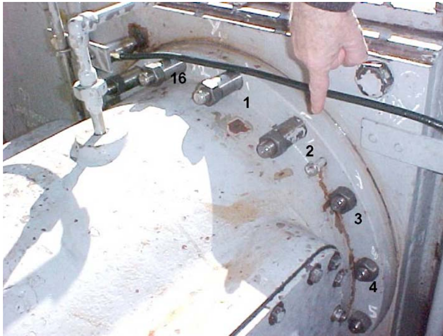
Figura 4 - Ilustração do conjunto carcaça/corrediça do pré-compressor representando a numeração escolhida para identificação dos parafusos.
