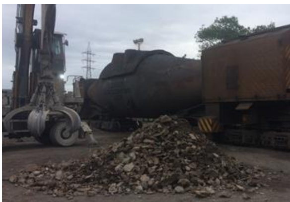
Figura 6. Adição de SGD em CT via garra
