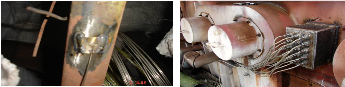
Figura 15. Foto de montagem dos termopares
