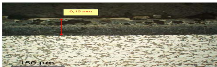
Figura 16. Análise metalográfica amostra de tubo após a limpeza química
