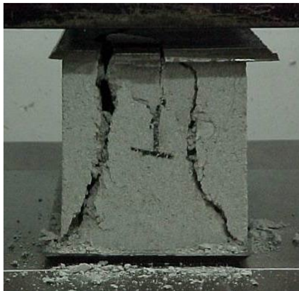
Figura 3. Blocos após processo de ruptura. Fonte: ABCP
