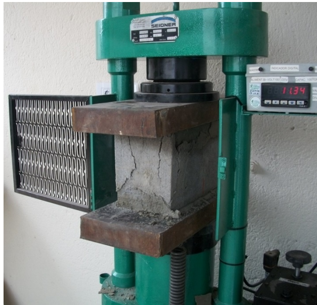
Figura 2. Ruptura de blocos de concreto para fins estruturais. Fonte: UFJF
