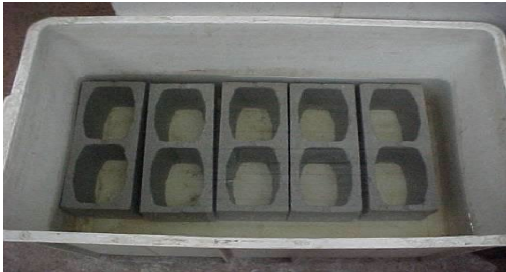
Figura 4. Blocos submersos para ensaio de absorção de água. Fonte: ABCP
